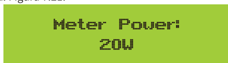
Figura 7.21 Funzione di esportazione-zero tramite contatore di energia acceso
